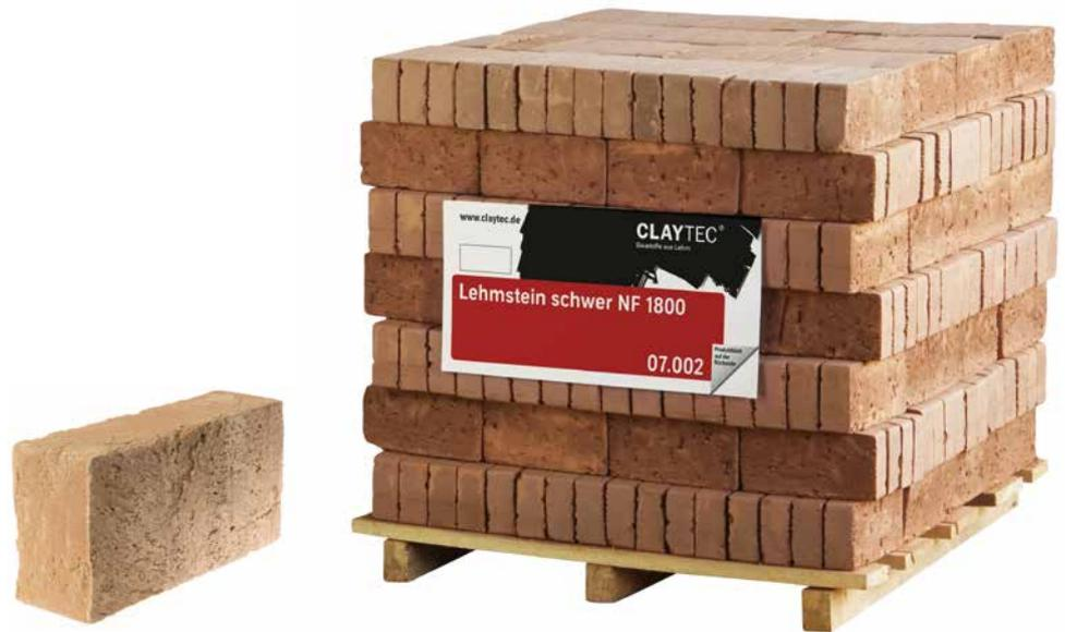
Schwerer formgeschlagener Lehmstein der Anwendungsklasse Ib (= zugelassen für tragendes Mauerwerk). Kann man mit Lehm tragend bauen? Ja, mit dem Lehmstein 1800 NF. Vor 30 Jahren entwickelte CLAYTEC diesen am Markt einzigartigen Stein. Das Normalformat (NF) macht ihn besonders geeignet für kleinteilige Reparaturen von historischen Massivlehmbauten. Als Mörtel ist Lehm-Mauermörtel schwer geeignet.
