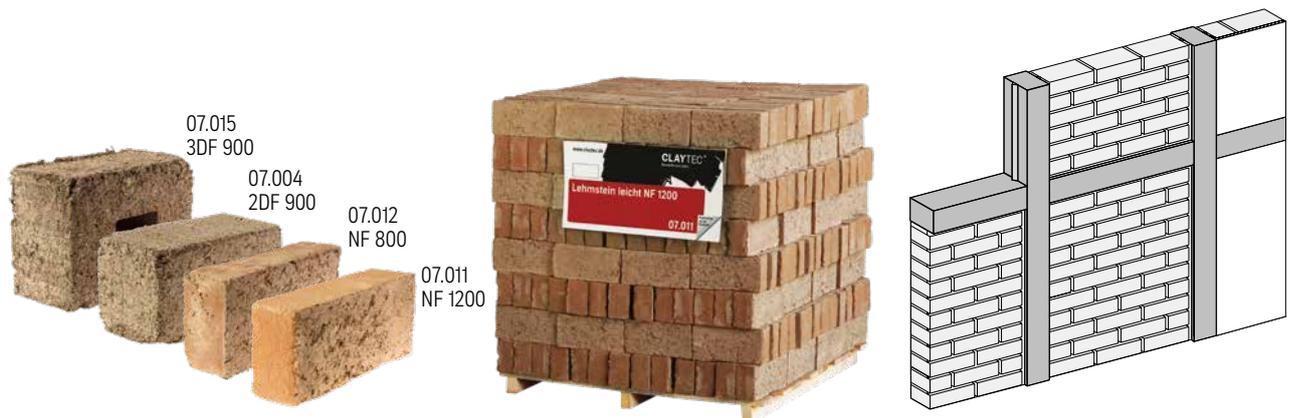
Leichter formgeschlagener Lehmstein der Anwendungsklasse Ia (= zugelassen für Fachwerkausmauerung). Die Zusammensetzung und Herstellungstechnik machen ihn sehr resistent gegen Nässe und Frost. Das althergebrachte Normalformat (NF) liegt gut in der Hand, die Größe ist für Fachwerk genau richtig. Der Lehmstein 1200 NF lässt sich bestens schlagen und schneiden. Als Mörtel ist Lehm-Mauermörtel leicht geeignet, für den Verputz Kalk-Grundputz Haar grob.
