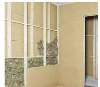
Trockenbauplatte aus Lehm zum Beplanken von Holz- und Metallständerkonstruktionen von Innenwänden, Vorsatzschalen, Decken- und Dachflächen. Die Lehmbauplatte schwer bringt viel Lehm ins Haus, mit allen positiven Auswirkungen für das Raumklima, besonders in thermischer Hinsicht. Sie ist leicht zu schneiden und erlaubt ein weites Trockenbau-Unterkonstruktionsraster von 62,5 cm.
