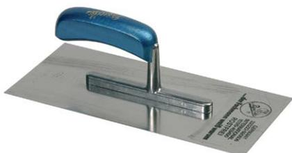
Stahl, rostfrei, gehärtet und poliert. Blattstärke 0,7 mm. Nieten rostfrei. Leichtmetallstütze und gebogener lackierter Holzgriff. **Großflächiger Glätter für das Aufziehen von Lehm-Unterputz und Lehm-Oberputz grob und fein.** Auch zum Verteilen von angeworfenem oder angespritztem Mörtel auf der Putzfläche sowie zur Egalisierung der Putzmasse.
