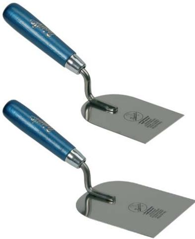
Federbandstahl, rostfrei, gehärtet und hochglanzpoliert. Blattstärke 0,8 mm. Angel aus rostfreiem Rundstahl, Blatt angepunktet. Lackierter Holzgriff. **Halbrundkelle mit geradem Abschluss für das Anwerfen und nachfolgendem Vorglätten kleinerer Mörtelmengen.** Für Beiputz- und Ausbesserungsarbeiten. Geeignet für Lehm-Unterputz, Lehm-Oberputz grob und fein.
