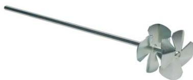
Stahl, verzinkt. Mit zwei gegenläufigen Vierflügel-Mischtellern. Sechseckschaft Ø 10 mm. **Zur Aufbereitung von CLAYFIX Lehm direkt.** Zum Einspannen in Elektrobohrmaschinen.
