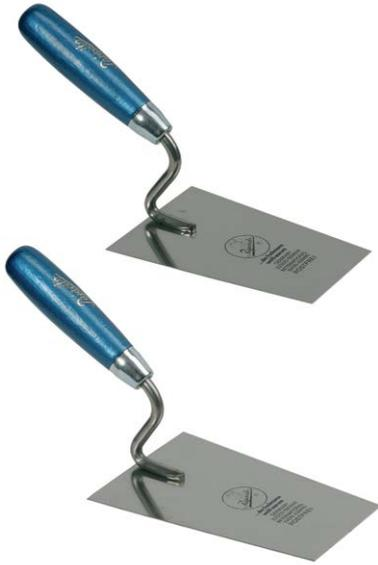
Federbandstahl, rostfrei, gehärtet und hochglanzpoliert. Blattstärke 1,0 mm. Angel in Schwanenhalsform aus rostfreiem Rundstahl, Blatt angepunktet. Lackierter Holzgriff. **Konisch geformte Kelle für die Entnahme des Mörtels aus dem Kübel und den Auftrag auf das Putzmörtelbrett 181/98160 und /98170.** Auch zum Anwerfen von Mörtel aus dem Handgelenk und für das Anmischen kleiner Mörtelmengen im Kübel. Geeignet für alle Lehmputze.
