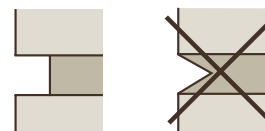
richtiges Auskratzen der Fuge!
