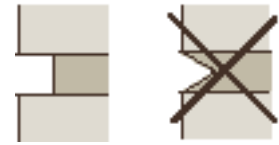
richtiges Auskratzen der Fuge
